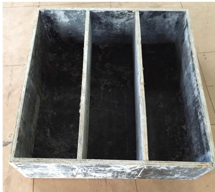
Figura 4.8 – Forma de madeira para moldagem dos corpos de prova
