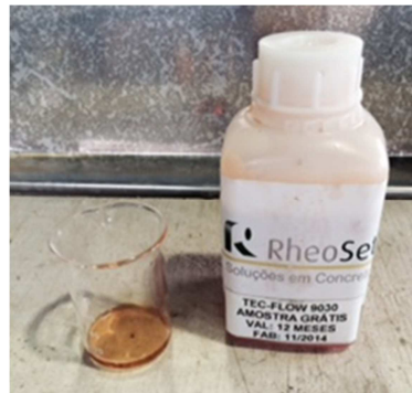
Figura 3.3 - Aditivo superplastificante de base policarboxílica
