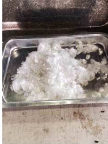
Figura 3.2 - Fibra de Polipropileno de alta tenacidade
