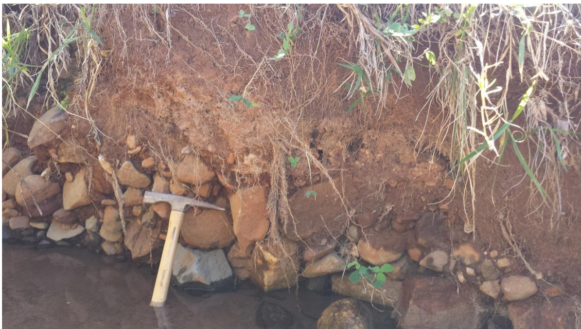
Figura 17 - Depósito coluvial descrito em local que abriga as nascentes do Ribeirão Vovozinha
