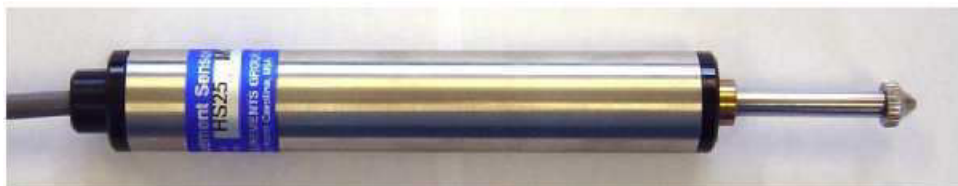
Figura 3.6: Transdutor (LVDT) para medição de deslocamentos.
