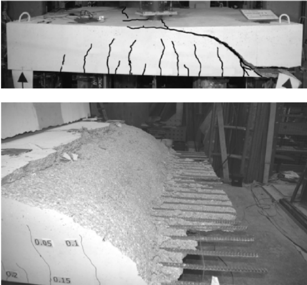
Figura 2.15: Fissura crítica de flexo-cortante
