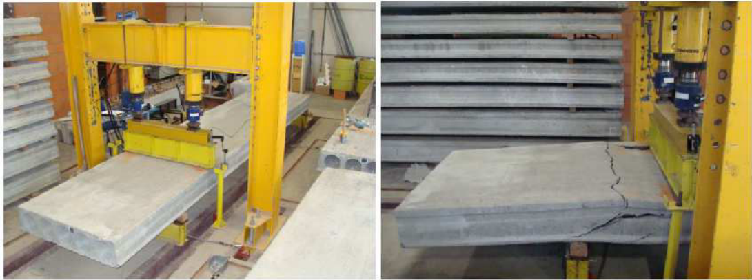
Figura 3.17: Laje LA09 e sua ruptura
