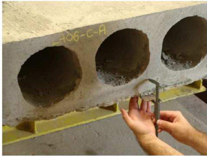
Figura 3.1: Medição realizada com paquímetro na seção transversal da laje
