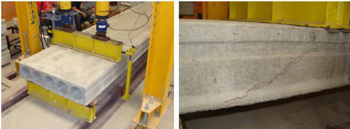
Figura 3.15: Laje LA04 e sua ruptura
