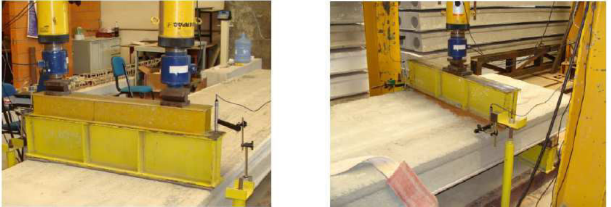
Figura 3.5: Vigas de transmissão, rótulas e chapas metálicas posicionadas
