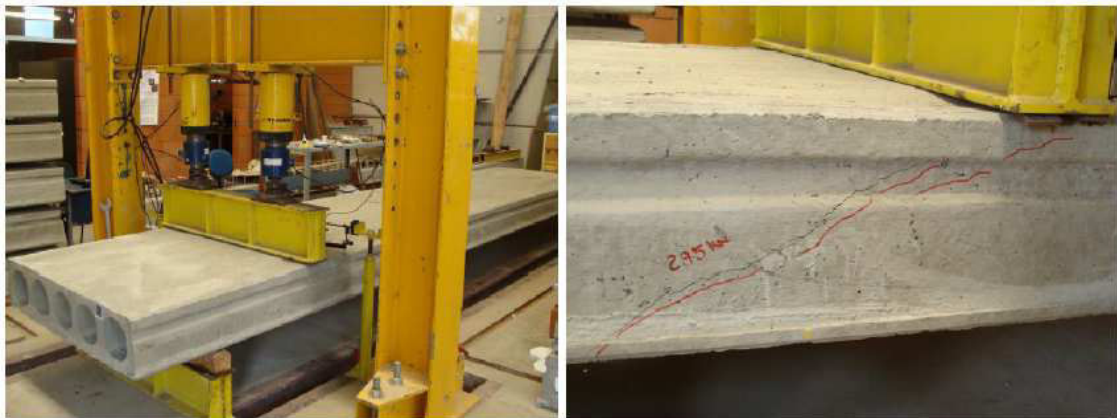
Figura 3.16: Laje LA06 e sua ruptura
