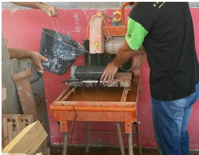
Figura 3.12 – Corte dos testemunhos de concreto
