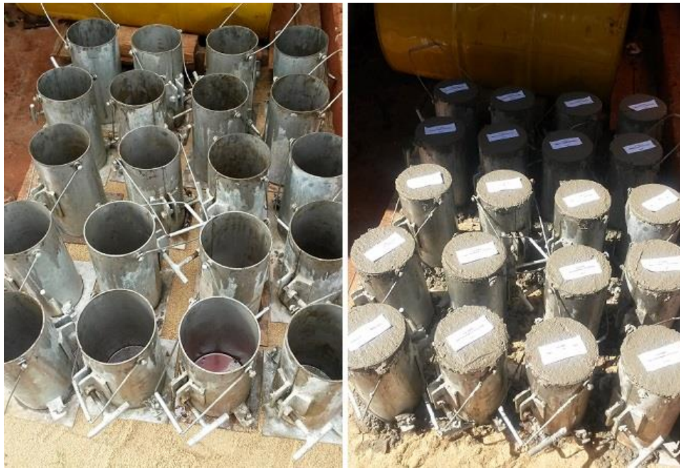
Figura 3.5 – Moldagem dos corpos de prova cilíndricos em canteiro
