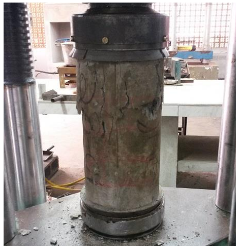
Figura 3.21 – Ensaio de determinação da resistência à compressão
