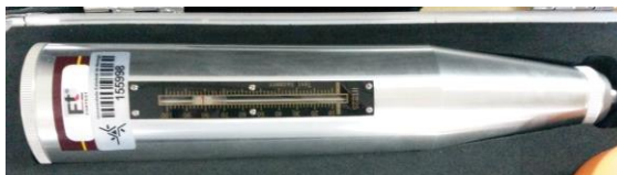
Figura 3.13 – Esclerômetro analógico de impacto Schmidt
