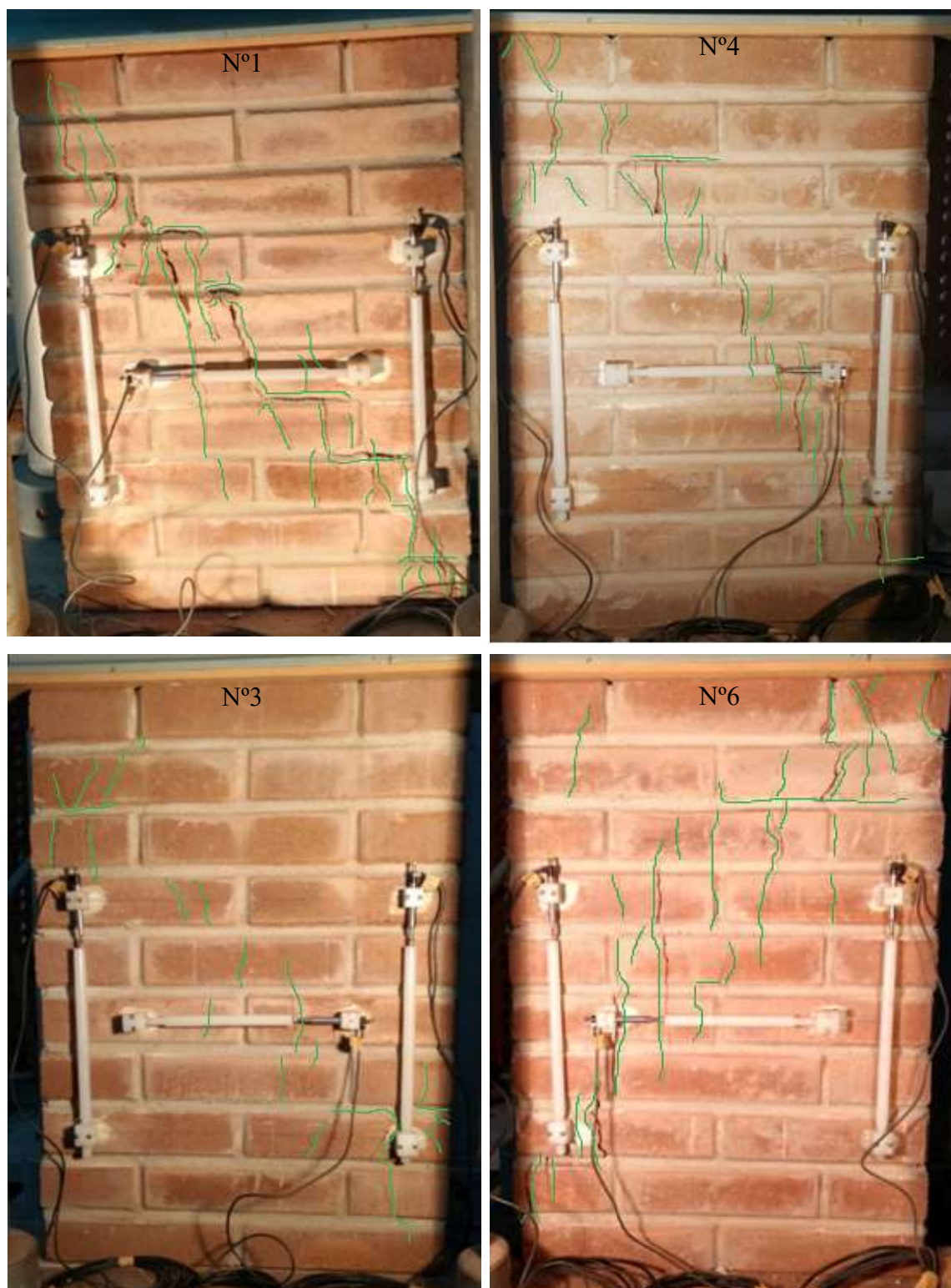
Figura 75 – Modo de ruptura das paredes de nº1, 3, 4 e 6
