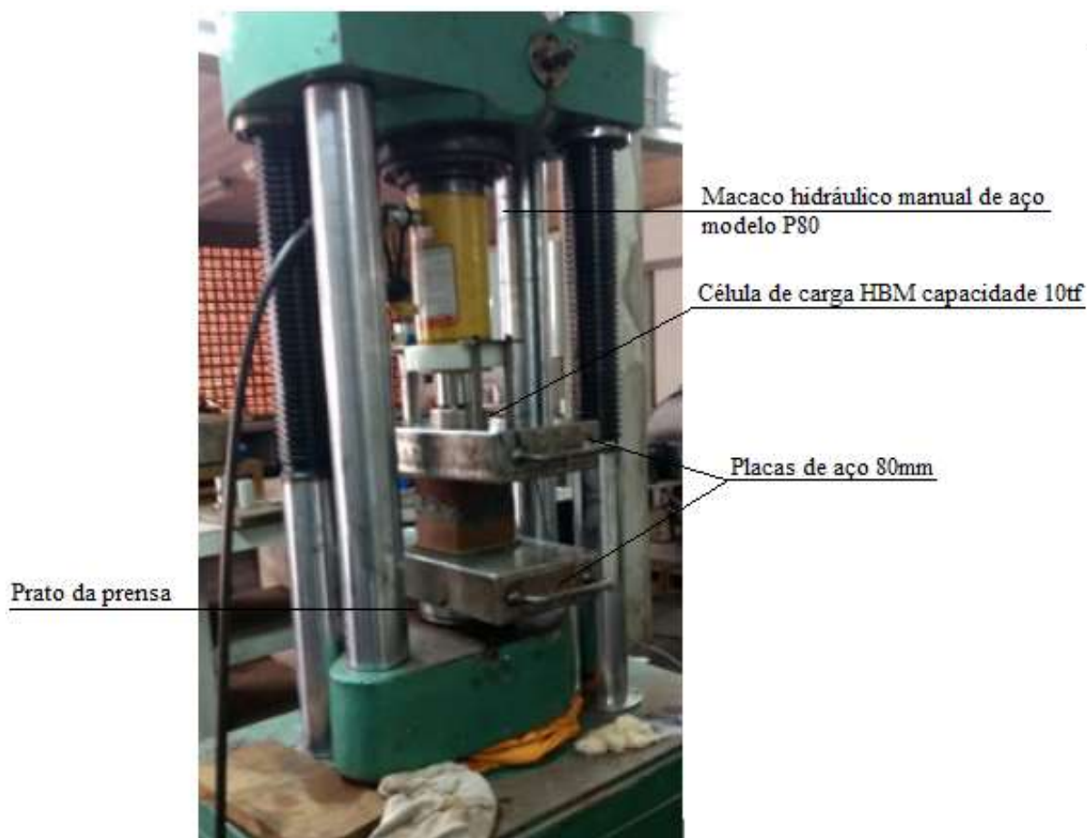
Figura 43 –Esquemática do ensaio de resistência à compressão
