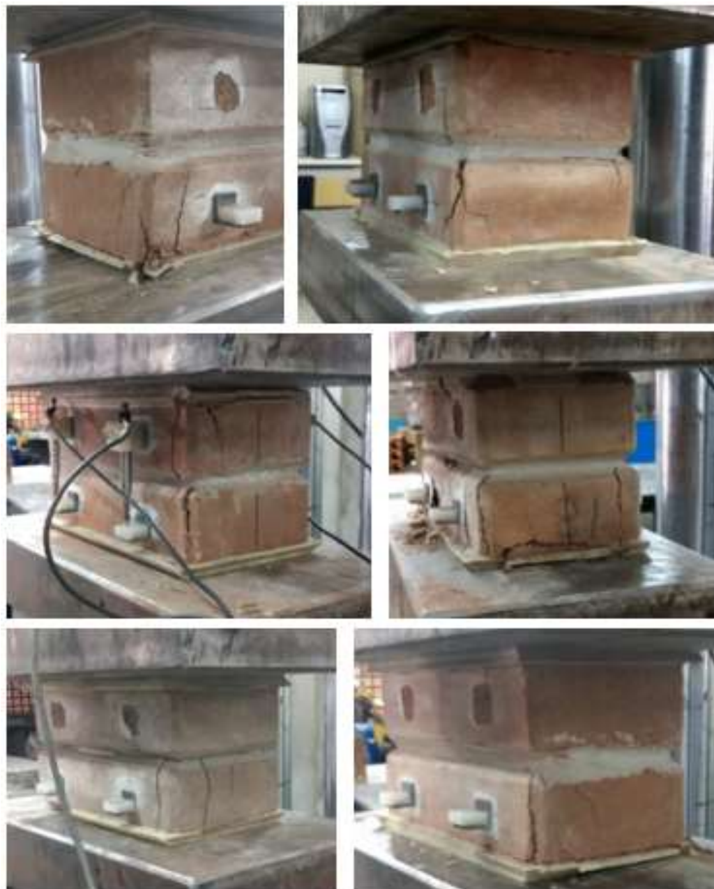
Figura 76 – Fissuras na ruptura dos prismas
