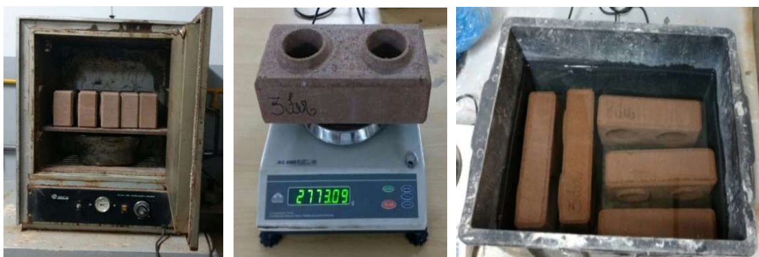
Figura 44 – Procedimento do ensaio de absorção dos tijolos aos 530 dias
