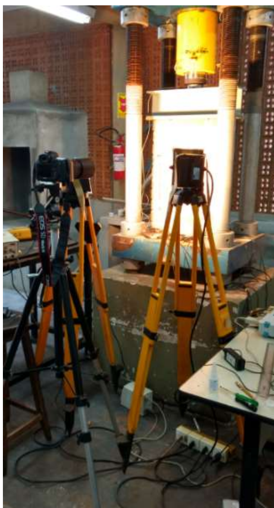
Figura 63 – Posicionamento da câmera e das luminárias
