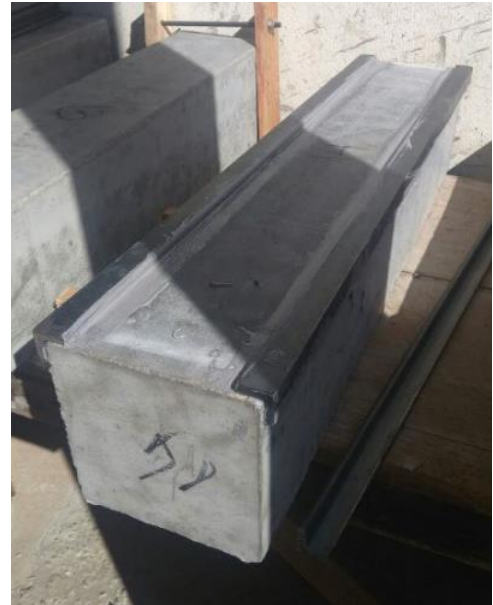
b) Fixação do reforço no substrato
