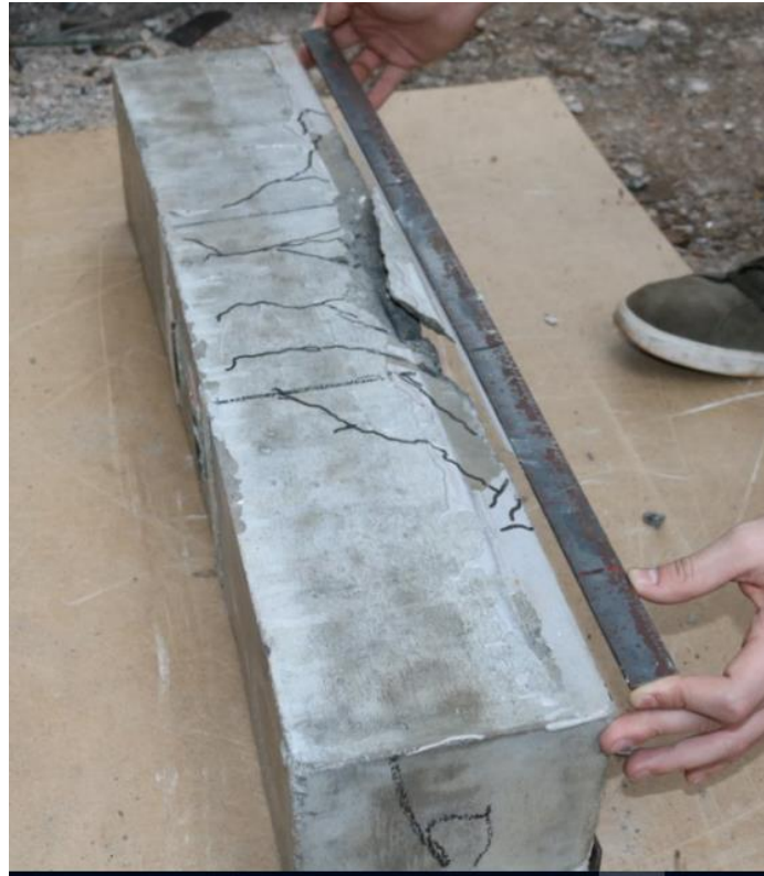
Figura 6.19 – Reforço descolado da Viga B1
