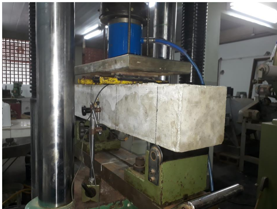
Figura 6.11 – Montagem da Viga A1 na prensa para ensaio
