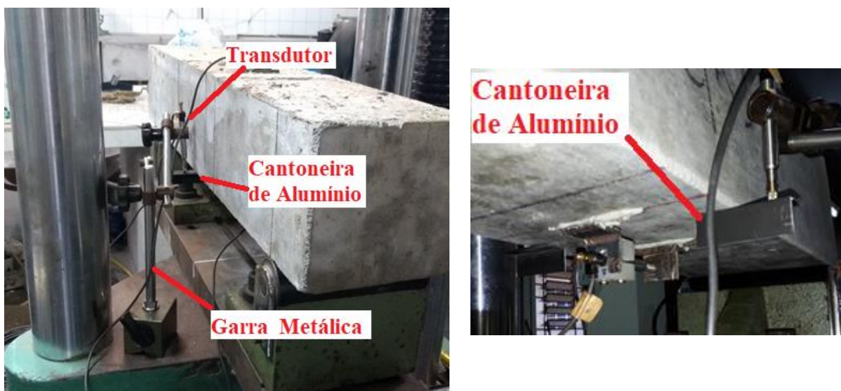
a) Montagem da garra metálica
