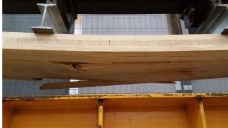
Figura 4.9 – Ruptura do painel P10 testado à flexão
