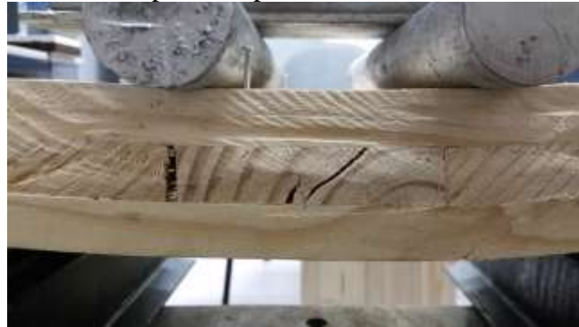
Figura 4.15 – Ruptura do painel P9 testado ao cisalhamento
