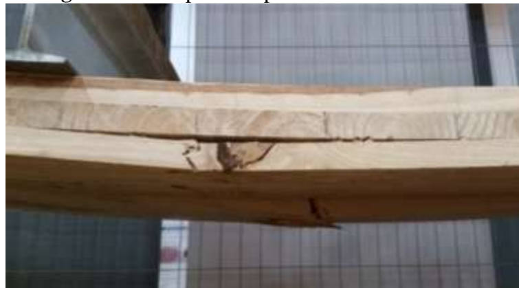
Figura 4.8 – Ruptura do painel P9 testado à flexão
