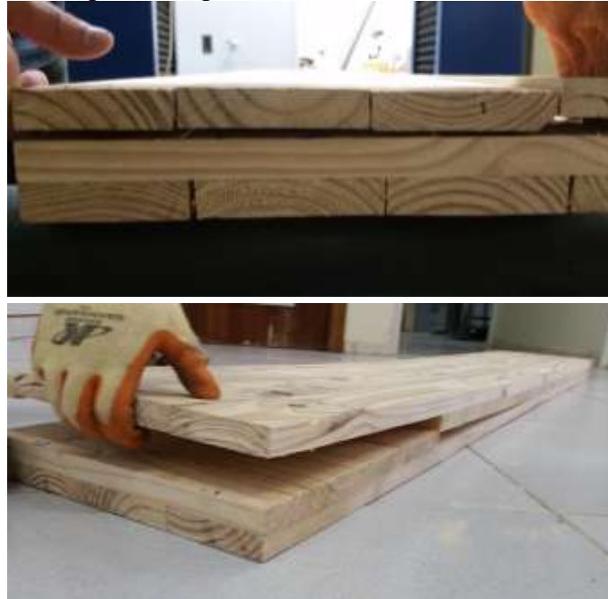
Figura 4.7 – Ruptura dos painéis com consumo de adesivo de 160 g/m 2
