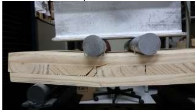
Figura 4.16 – Ruptura do painel P11 testado ao cisalhamento
