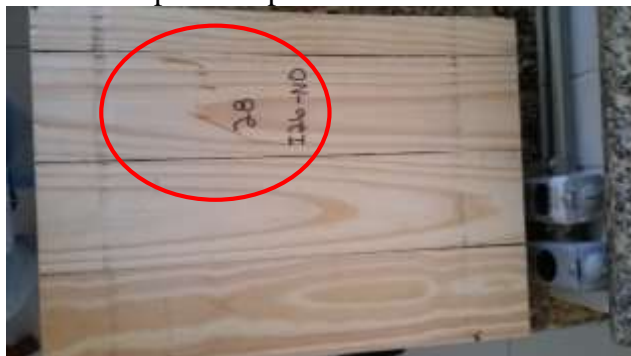
Figura 4.13 – Ruptura do painel P10 testado ao cisalhamento
