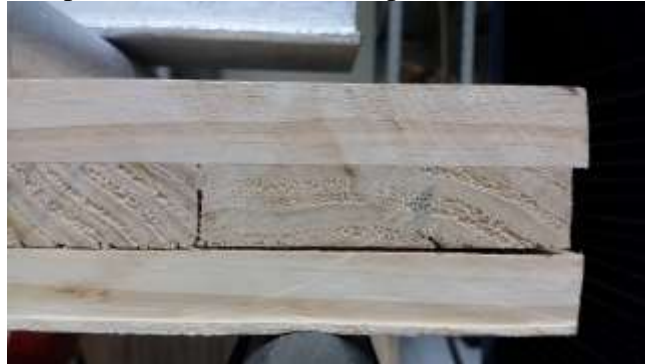
Figura 4.17 – Ruptura na linha de cola do painel P3 testado ao cisalhamento
