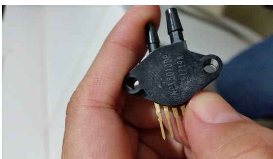
Figura 3.16: Sensor de Pressão - MPX5010DP Fonte: Própria (2019)
