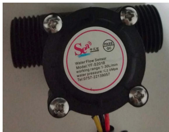
Figura 3.18: Sensor de Fluxo - FS300A e YF-S102B Fonte: Própria (2019)
