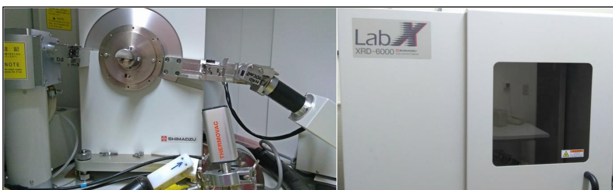
Figura 3.5 Difratômetro de raios X utilizado na identificação das fases.
