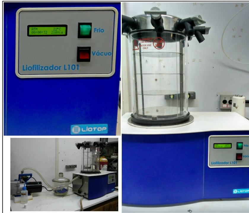
Figura 3.1 Liofilizador da Liotop utilizado no processamento das amostras.
