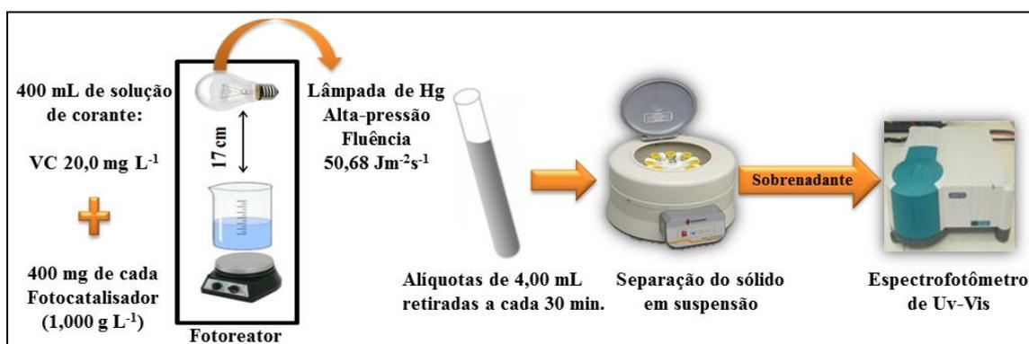
Figura 10 - Esquema do experimento de fotocatalise.
