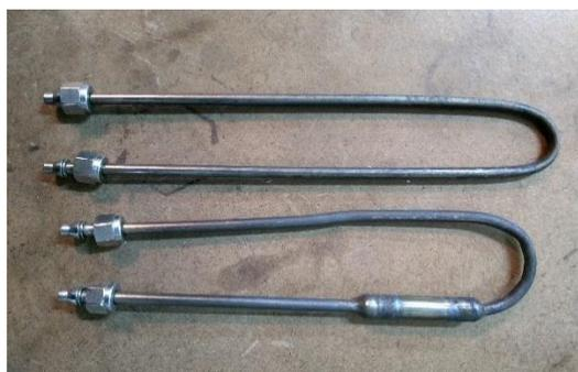
**Figura 43** – Reatores disponíveis para o módulo reacional 1.
