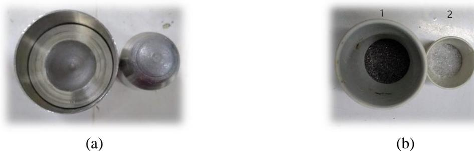
**Figura 13** – (a) Pilão utilizado para preparar grãos de vidro. (b) Vidro após uma reação: (1) vidro utilizado a jusante do reator (2) vidro utilizado a montante do reator.
