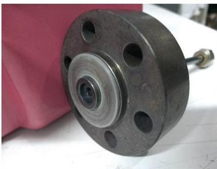
**Figura 12** – Junta feita para a tampa de um dos lados do reator.
