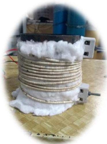
**Figura 44** – Resistência improvisada para o módulo reacional 1.
