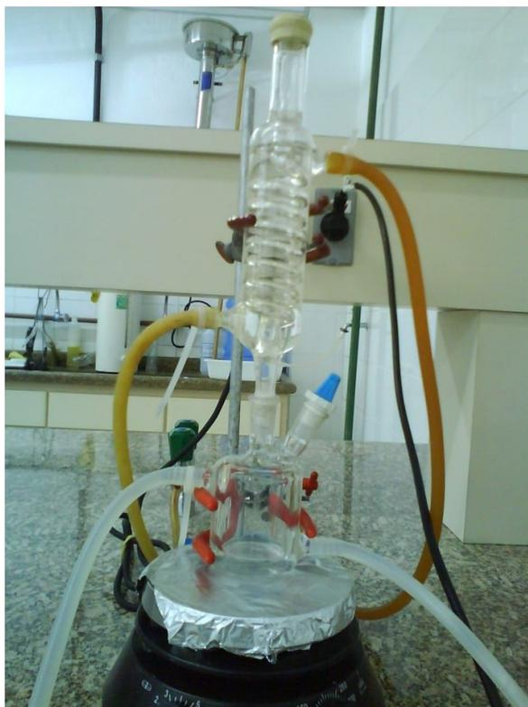
Figura 3.1. Reator de vidro utilizado para síntese de biodiesel.
