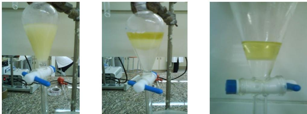
**Figura 3.2.** Decantação do biodiesel.
