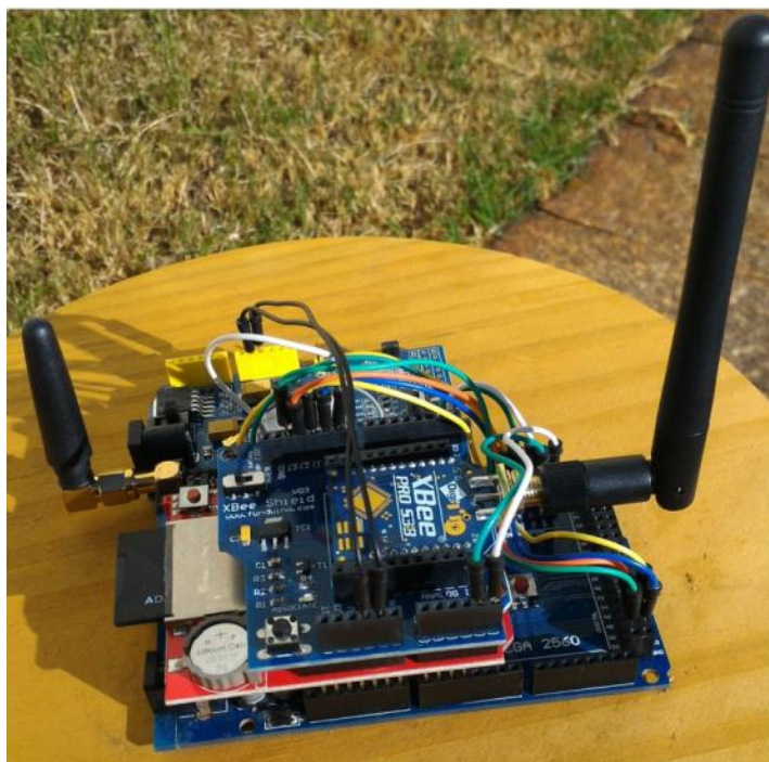
Figura 3-10 – Montagem dos shields com o Arduino Mega
