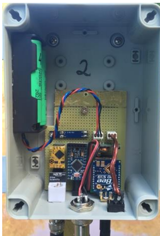
Figura 3-8 – Nó sensor montado em gabinete Steck
