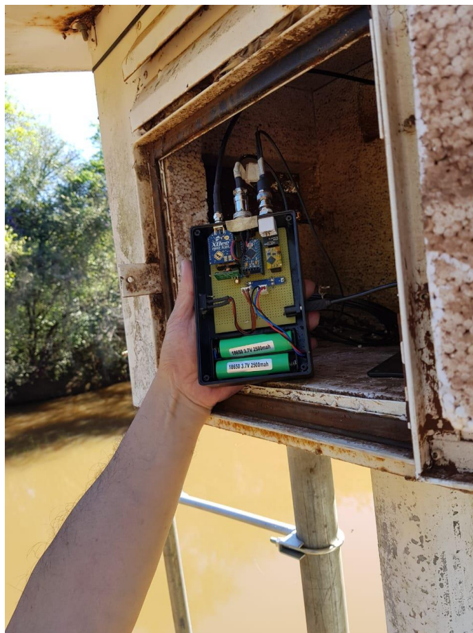
Figura 3-29 – Circuito do nó sensor do Ponto1
