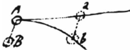
Figura 5 - Desenho original de Newton, ilustrando o caso de força contínua de sua segunda lei: a deflexão móvel é igual à deflexão de repouso, \overline{ab} = \overline{AB}
