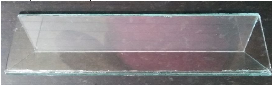
Figura 38 - Imagem fotográfica do prisma de vidro com 25 cm de comprimento e 7 cm de aresta, utilizado pelos alunos da Equipe 1.
