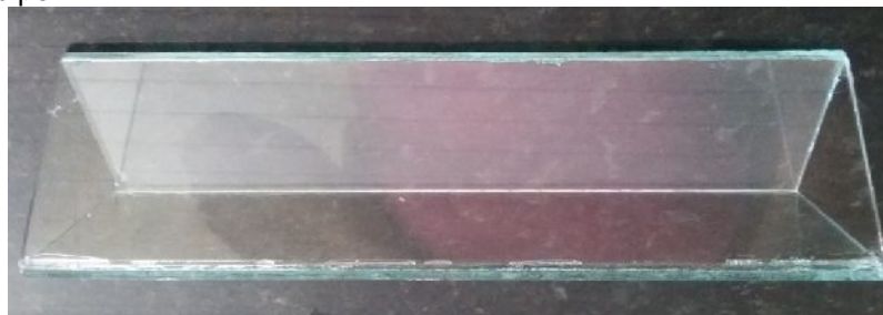
Figura A.1 – Imagem fotográfica do prisma de vidro com 25 cm de comprimento e 7 cm de aresta utilizado pela Equipe 1.
