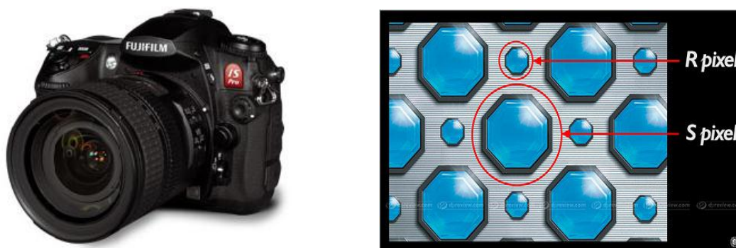
FIGURA 6 – Câmera Fujifilm IS PRO e seu esquema do sensor super CCD SR PRO.
