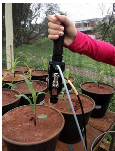
FIGURA 5 – Leitura com ASD Plant Probe.
