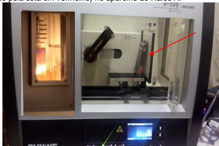
Figura 2.2 – Fotografia registrada no momento em que fora inserida uma calculadora comum dentro da embalagem (indicado pela seta em vermelho) no aparelho de Raios X.
