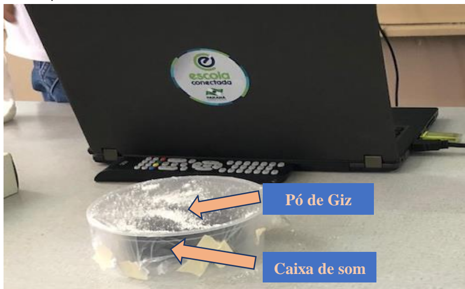
Figura 3.2 - Imagem fotográfica do aparato experimental para experimento realizado pelos alunos em sala de aula para ilustrar o efeito da onda sonora. Indica-se o pó de giz para observar esse efeito, e a caixa de som com um recipiente de plástico cobertos por uma folha de plástico utilizados na realização do experimento.
