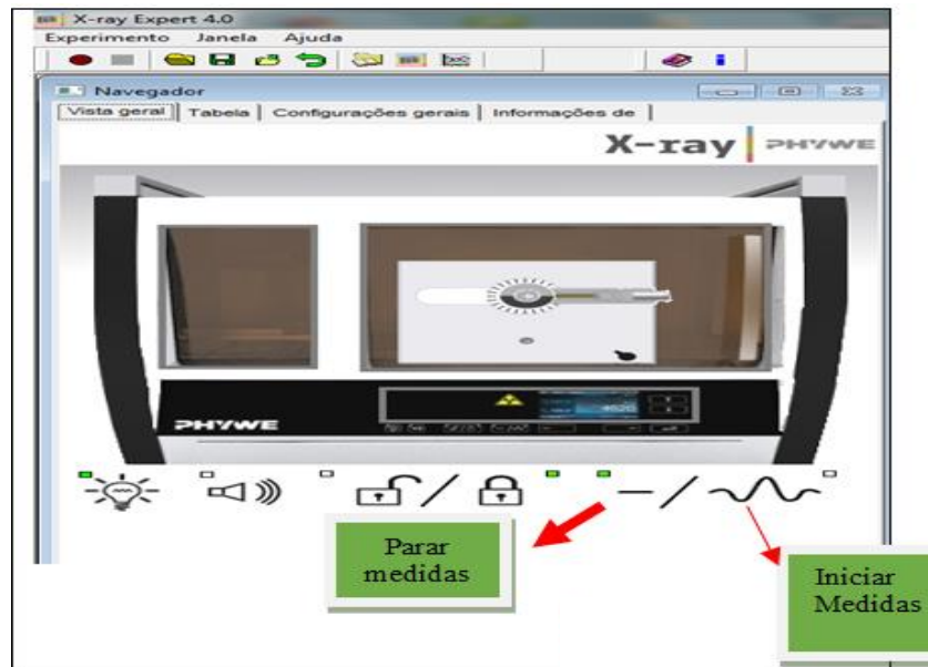
Figura 1.4- Imagem da tela ( printscreen ) acessada de forma remota para mostrar a tecla para iniciar e parar as medidas de Raios X via Measure .
