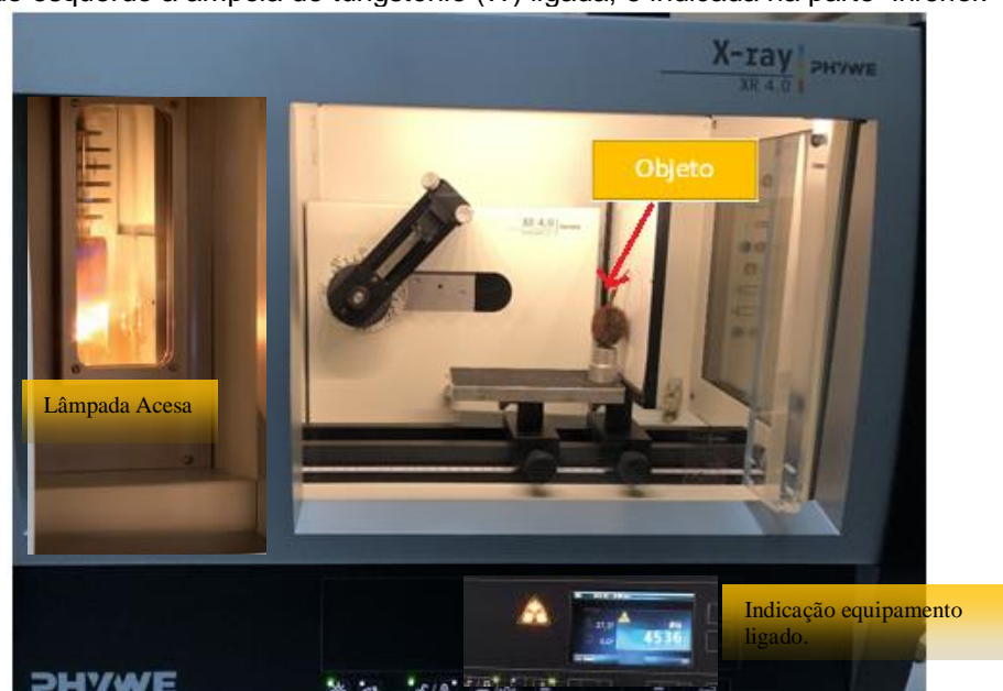
Figura 2.1 – Fotografia do aparelho de Raios X do tipo EXPERT 4.0 (PHYWE) contendo um objeto para análise. Neste caso o objeto é o fruto de Bixaorellana , conhecida comumente como Urucum ou colorau. No lado esquerdo a ampola de tungstênio (W) ligada, e indicada na parte inferior.
