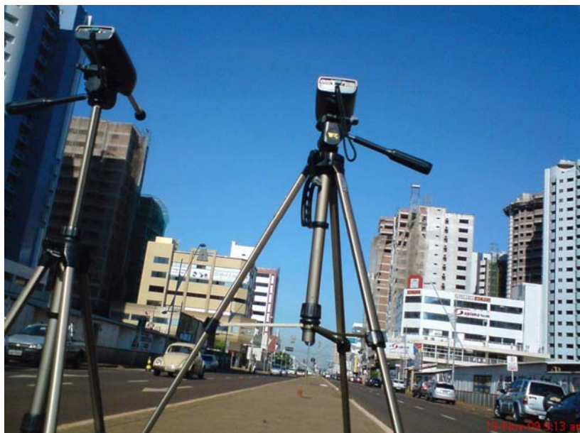
Figura 17 – Medições in loco com os sonômetros 01dB, modelo SdB02+
