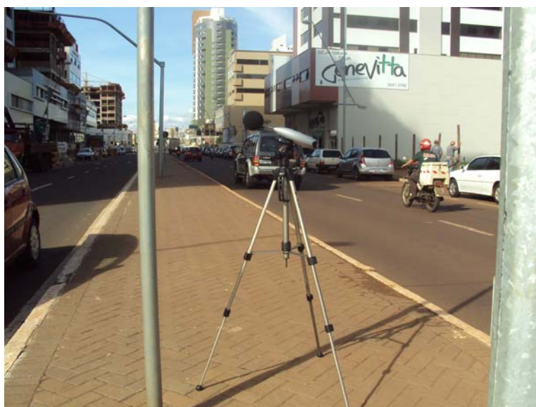
Figura 32 – Medição in loco com o sonômetro da Solo, modelo 01dB
