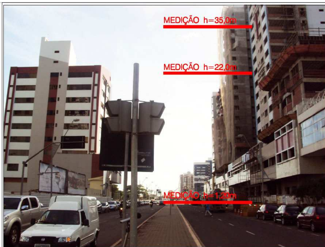
Figura 40 – Indicação das alturas das medições simultâneas no térreo e na fachada do edifício
