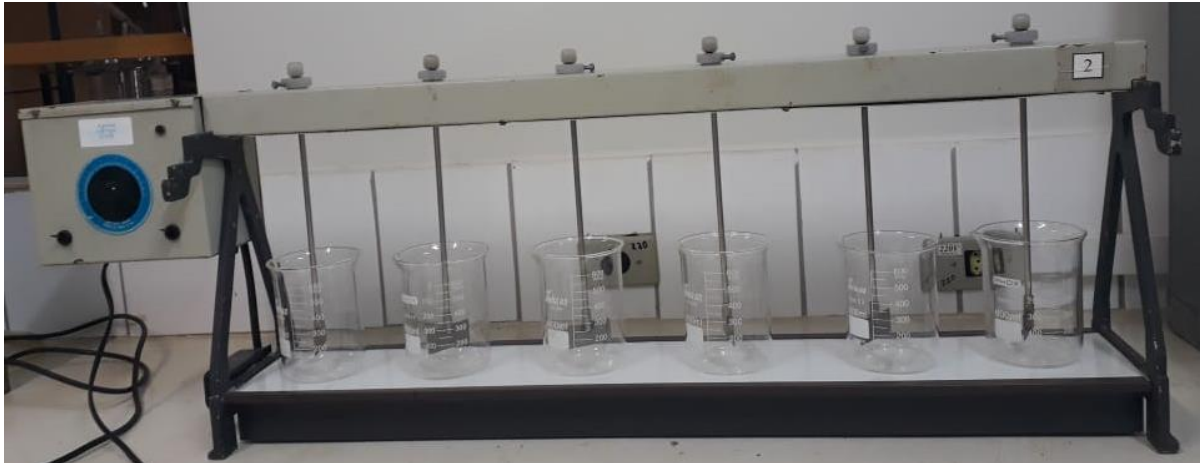
Figura 1 - Equipamento Jar Test da Universidade Estadual de Maringá - LGCPA
