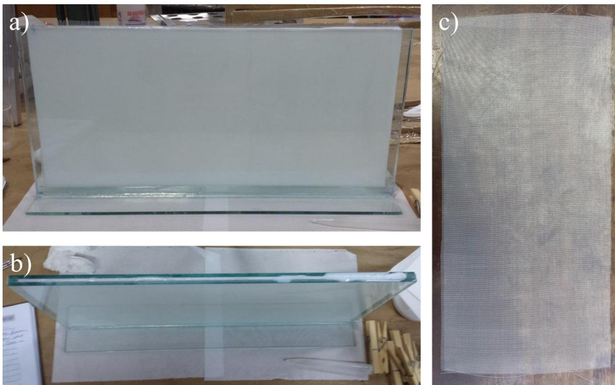
**Figura 3.2:** visão frontal da cuba (a), visão superior da cuba (b) e tela de poliéster limpa com dimensões de 38cm x 18cm (c).
