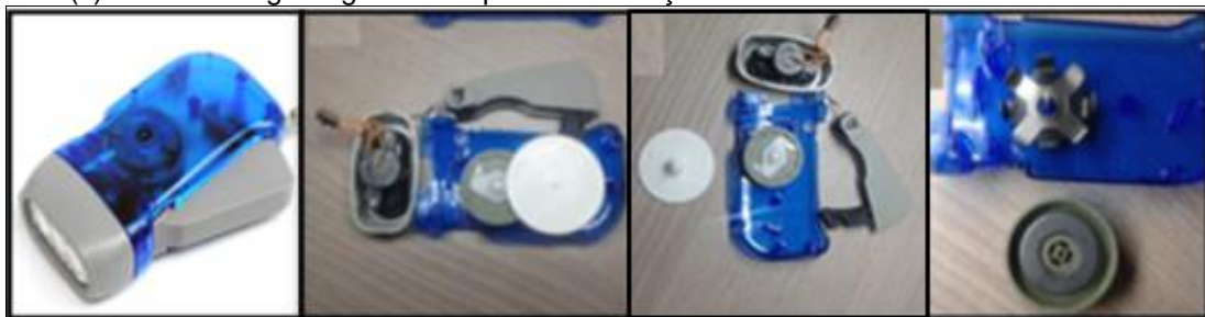
Figura 2.6 - Imagens fotográficas: (a) Lanterna de dínamo, (b) sem a tampa, (c) tirando a engrenagem branca e (c) tirando a engrenagem cinza para visualização do ímã.
