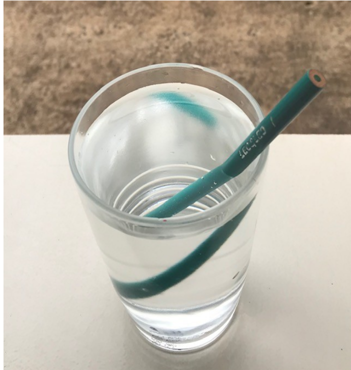
Figura12 – Ilustração da mudança de velocidade da luz ao atravessar de meio para outro meio. Fonte: O autor
