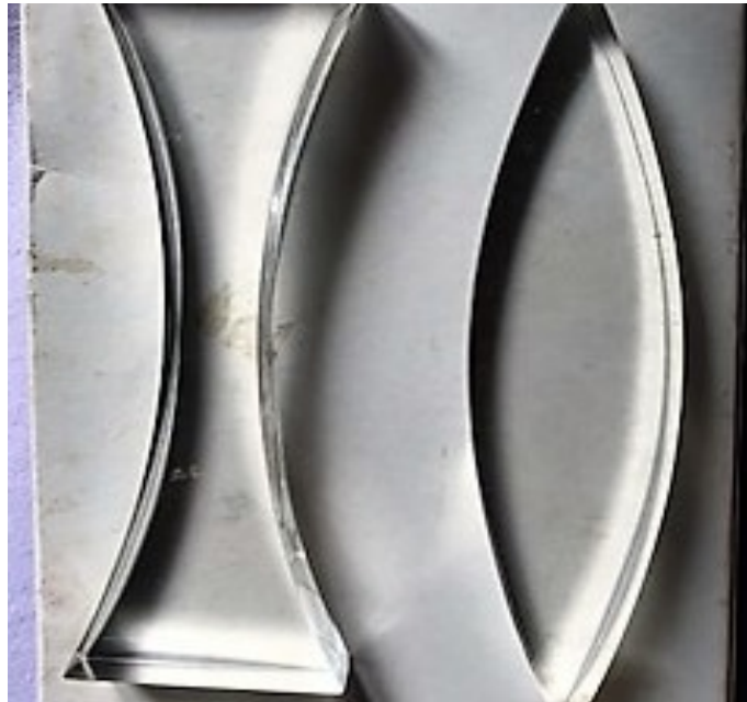
Figura 14 – Ilustração de lentes acrílicas divergente e convergente, respectivamente. Fonte: O autor
