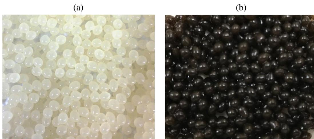
Figura 4.2 – Esferas de (a) alginato de cálcio e (b) bioissorvente imobilizado preparadas utilizando o método de gotejamento
