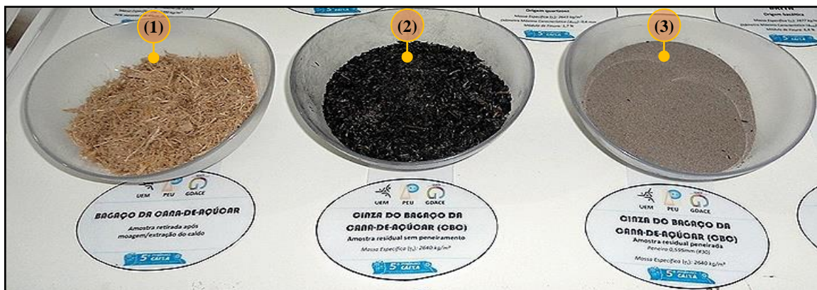
Nota: A imagem do detalhe (1) contém bagaço da cana de açúcar moído, já o detalhe (2) apresenta a CBC residual sem peneiramento e o detalhe (3) a CBC residual peneirada em malha de 2 mm. Fonte: adaptado de Nagano (2014).
