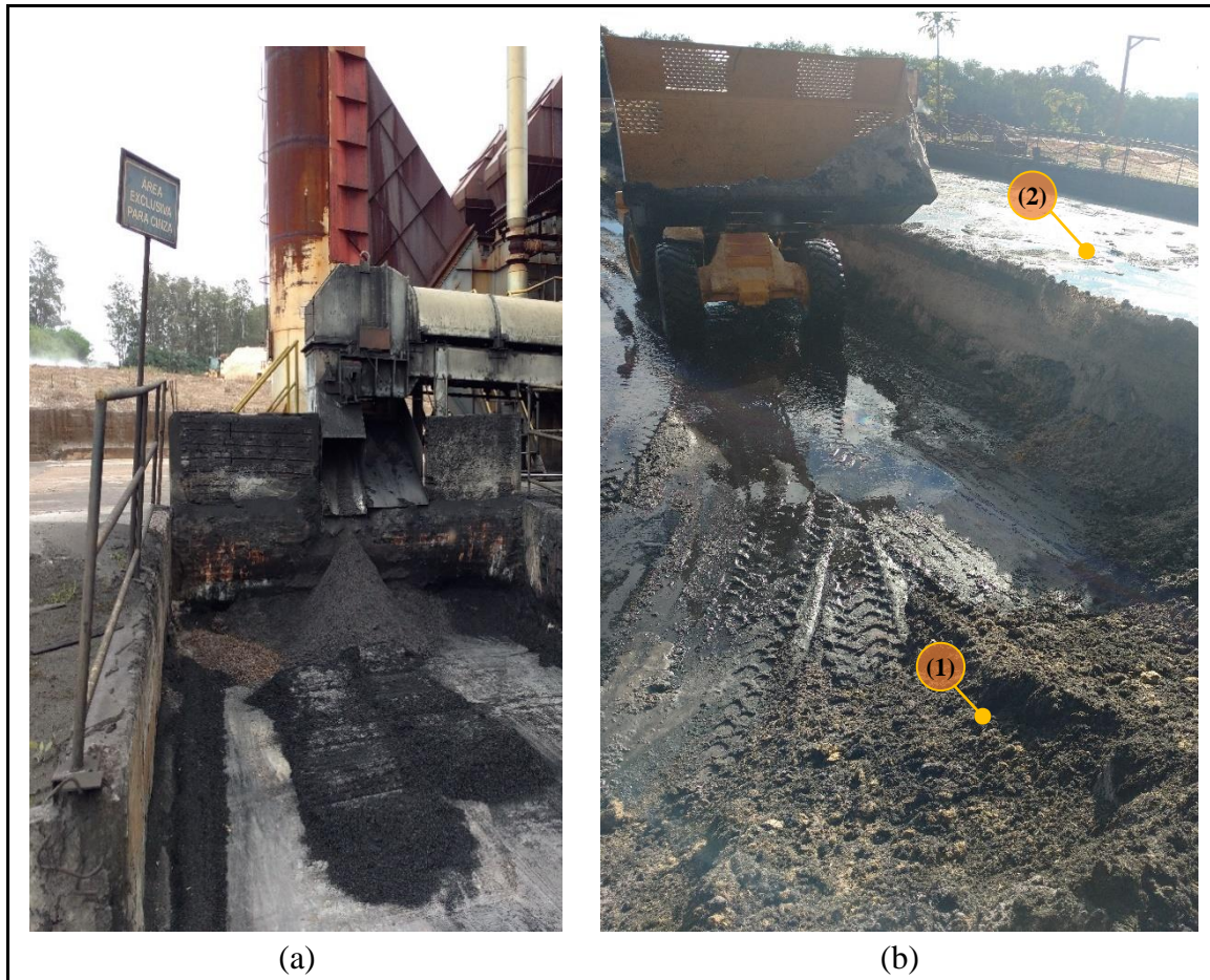
Figura 2.8 – Caixa de alvenaria e tanque de sedimentação
