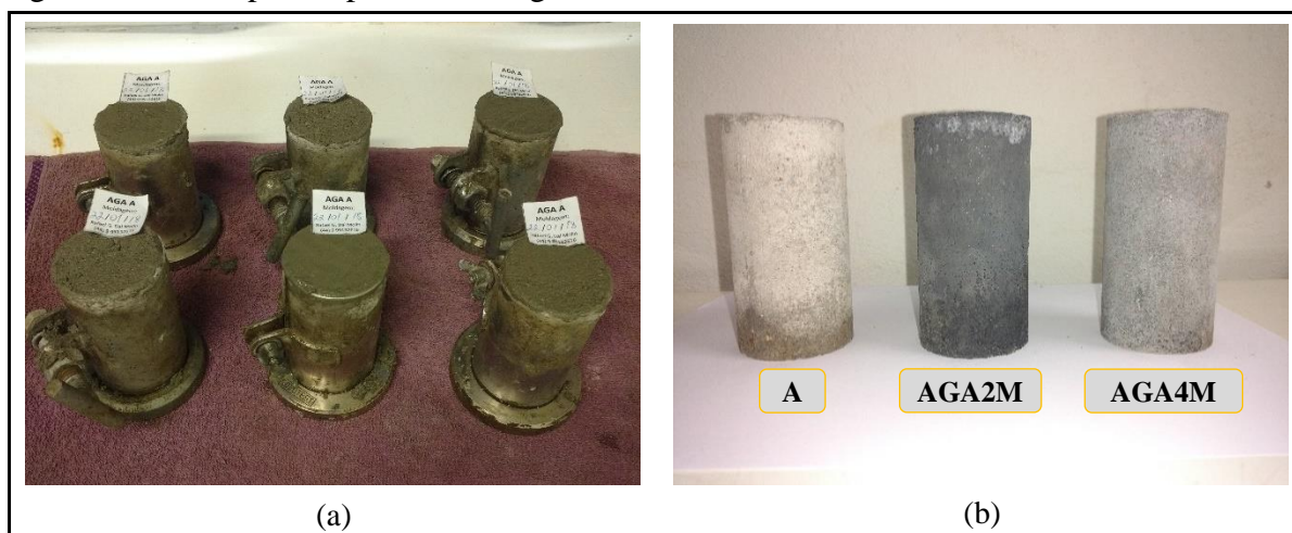
Figura 3.11 – Corpos de provas das argamassas
