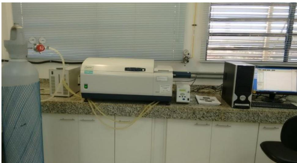
Figura 10. Equipamentos utilizados para análise de dicroísmo circular.
