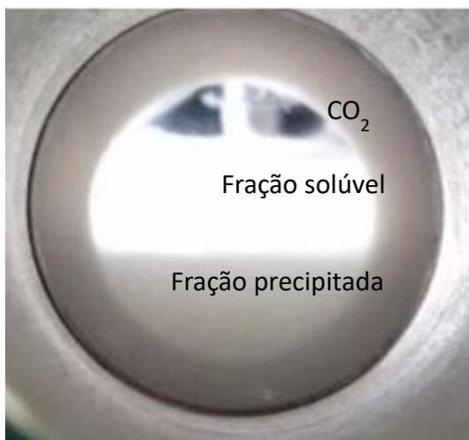
Figura 12. Precipitação de parte do material da suspensão aquosa de WPI em reator batelada.
