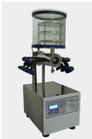
Figura 9. Liofilizador de bancada.
