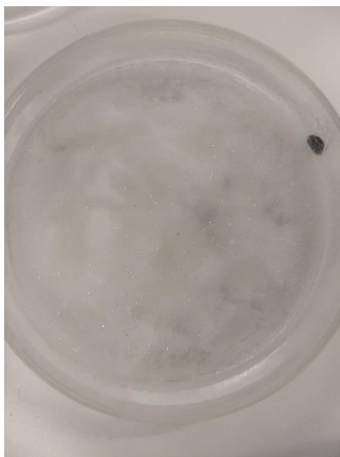
Figura A. 6 - Cristais produzidos no ensaio iniciado com a concentração inicial do Ponto 2 com semente de ácido glutárico.
