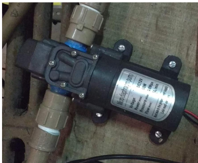
Figura 3.3 – Bomba de água e o circuito de controle de potência finalizados.
