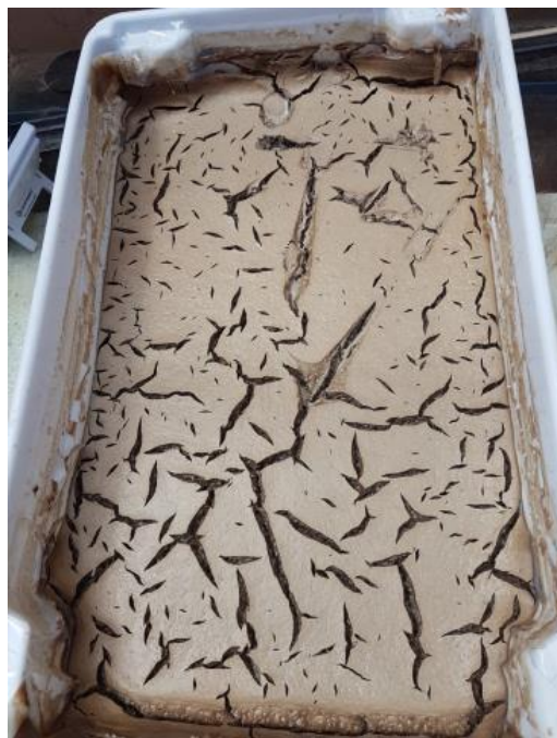
Figura 4.51. Aparecimento rachaduras ao final do segundo dia de secagem solar.
