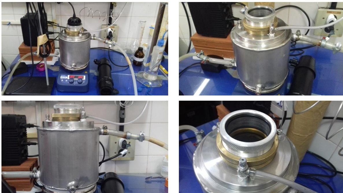
Figura 17 – Imagens do módulo experimental para a produção fotocatalítica de hidrogênio.
