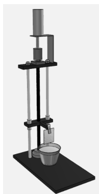
Figura 13– Representação esquemática do processo de deposição do filme de revestimento fotocatalítico pelo mecanismo de imersão dip-coating.
