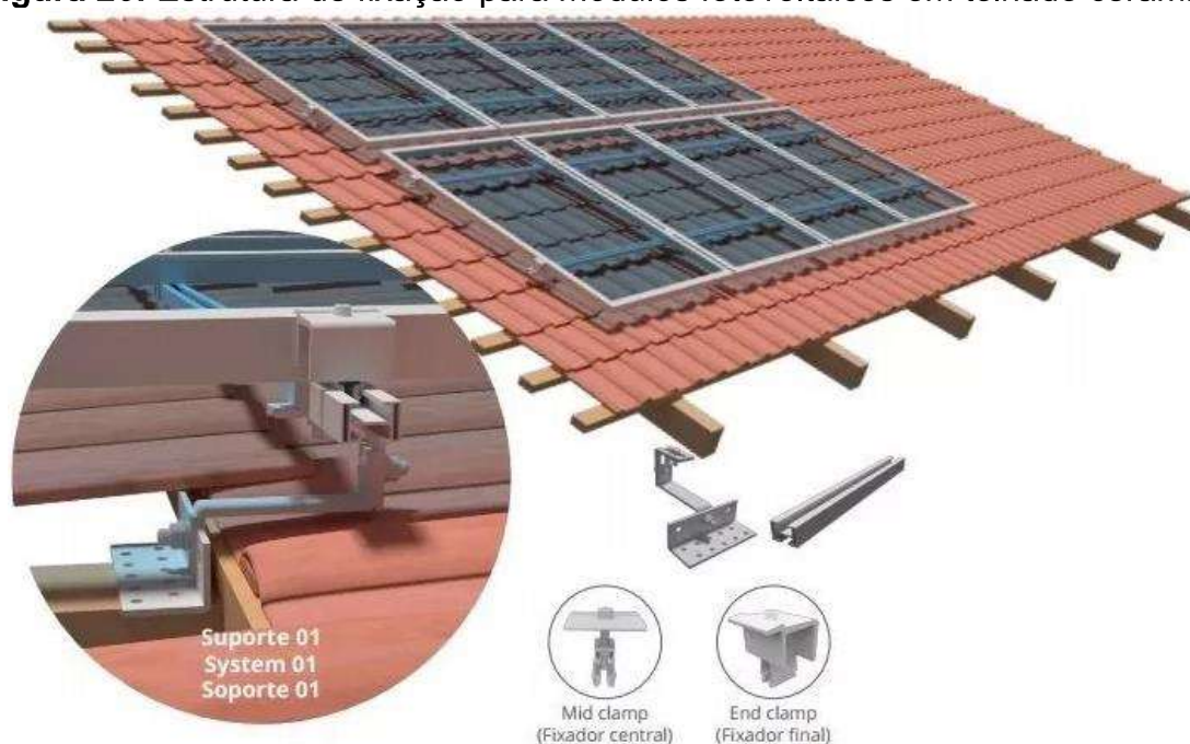
Figura 26: Estrutura de fixação para módulos fotovoltaicos em telhado cerâmico.
