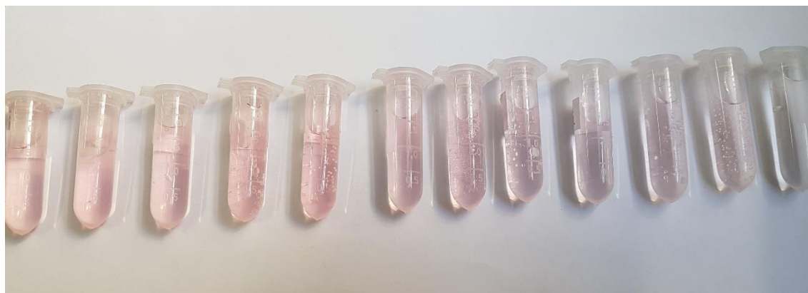
Figura 48: Amostras da descoloração do Vermelho Ponceau 4R na presença de ZnO, em 15, 30, 45, 60, 75, 90, 105, 120, 135, 150, 165 e 180 minutos de reação.
