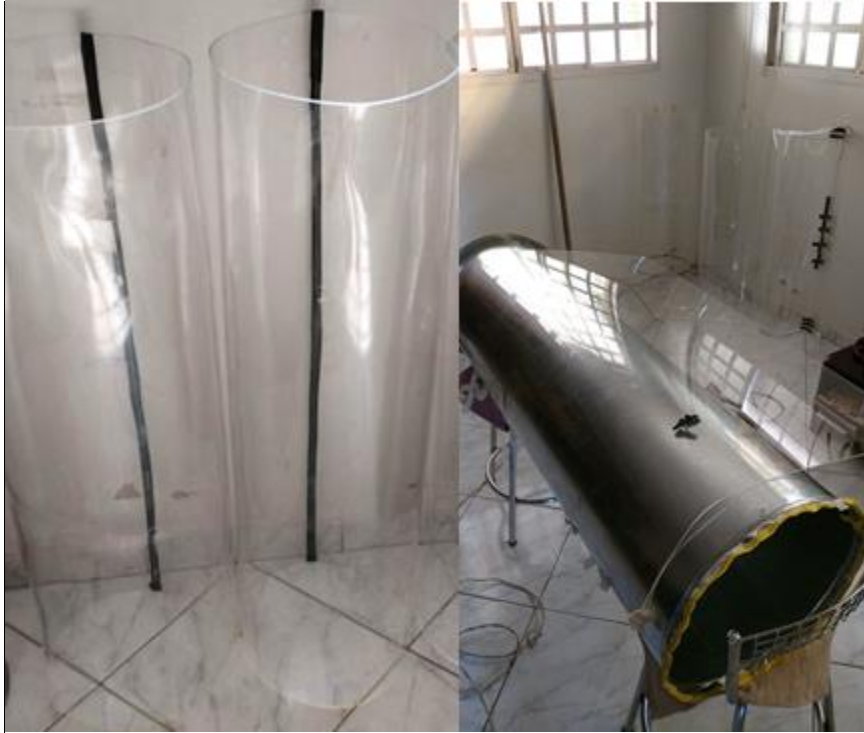
Figura 7. Tubos de acrílico durante o processo de moldagem.
