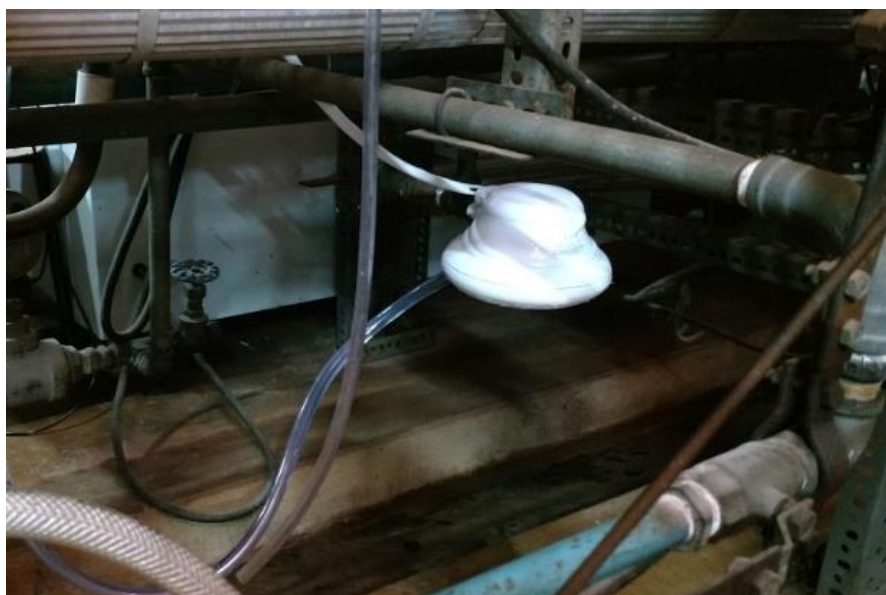
Figura 14. Resistência elétrica responsável por simular distúrbio na entrada.
