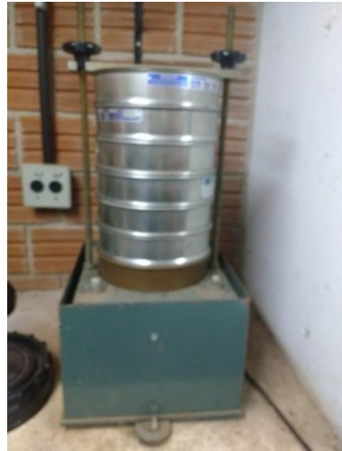
Figura 24 - Agitador mecânico utilizado nos ensaios de peneiramento
