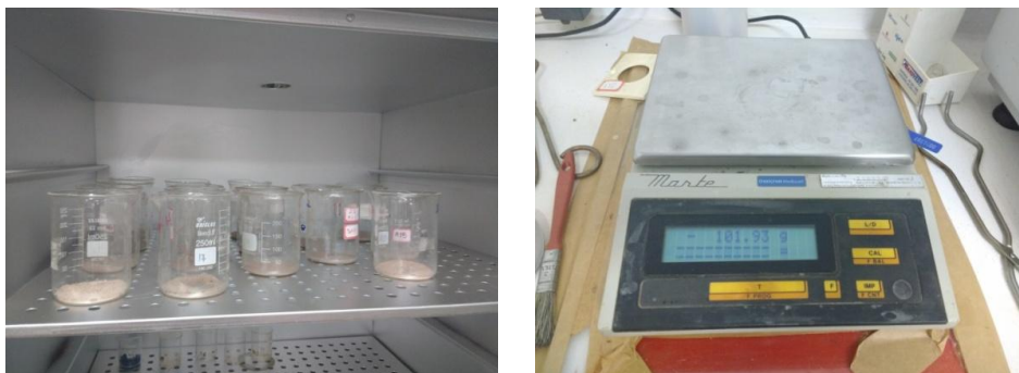
Figura 22 - Estufa para secagem das amostras e balança eletrônica de precisão 0,01g
