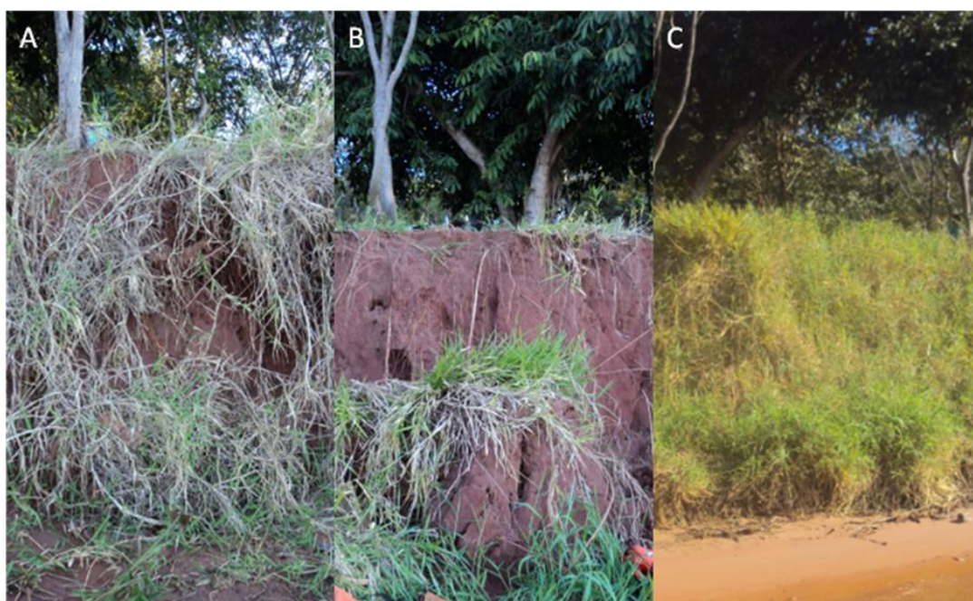
Figura 37 - Feições erosivas no ponto de controle 4, (A) e (B) seções 4.2 e 4.3 respectivamente, no primeiro monitoramento e (C) abrangendo ambas as seções no último monitoramento
