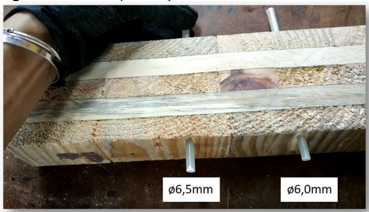
Figura 50: Teste de pré-furação das cavilhas de GFRP.
