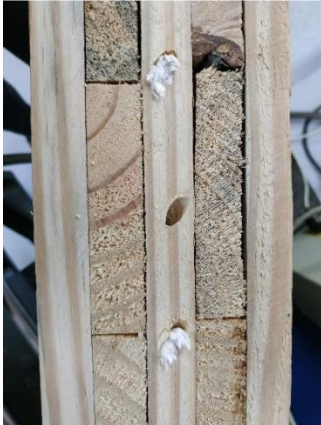
Figura 71: Cisalhamento das ligações posterior aos ensaios.
