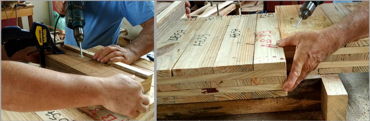
Figura 57: Processo de pré-furação do corpo de prova da junta de extremidade.
