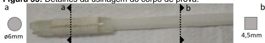
Figura 35: Detalhes da usinagem do corpo de prova.
