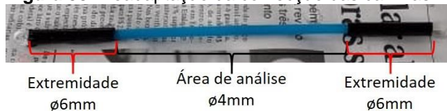
Figura 38: Readaptação da confecção das cavilhas.
