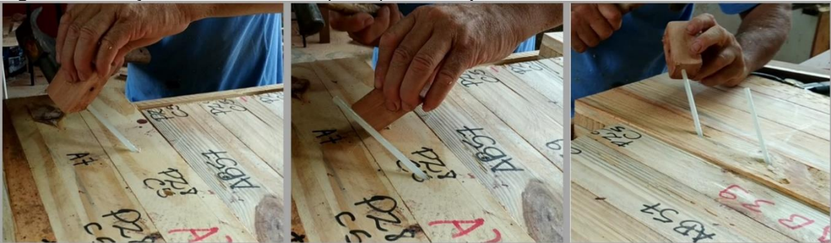
Figura 58: Inserção das cavilhas no corpo de prova com junta de extremidade.
