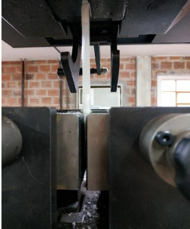
Figura 33: Corpo de prova na parte superior: escorregamento nos mordentes.
