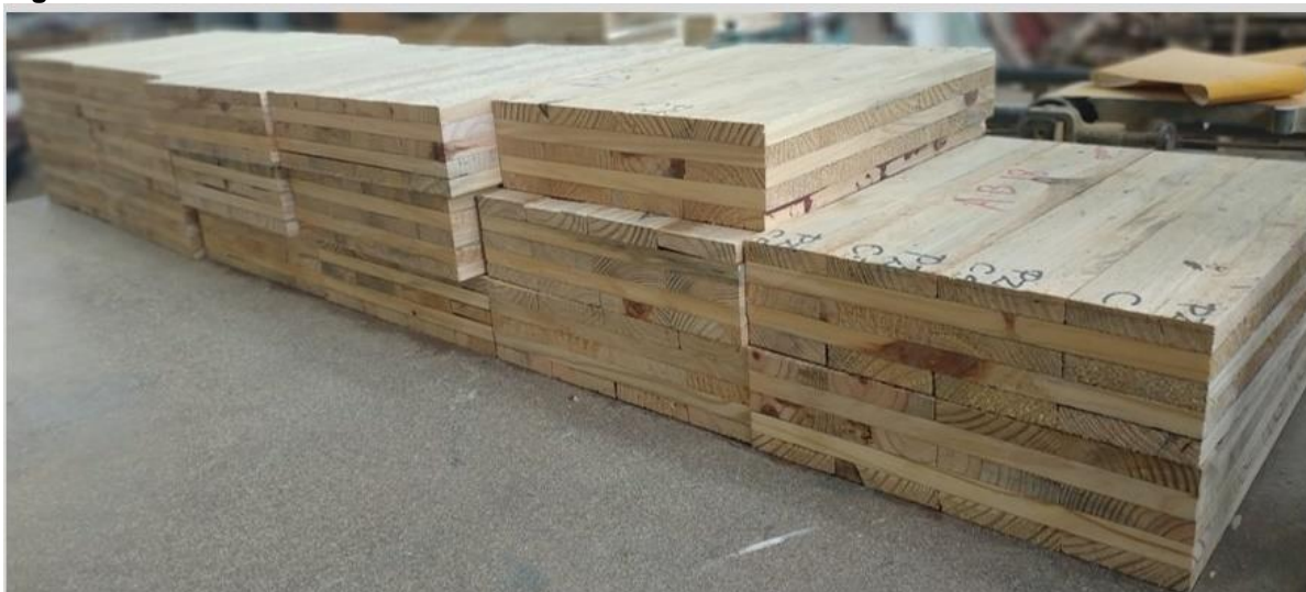
Figura 77: Painéis de CLT concluídos.
