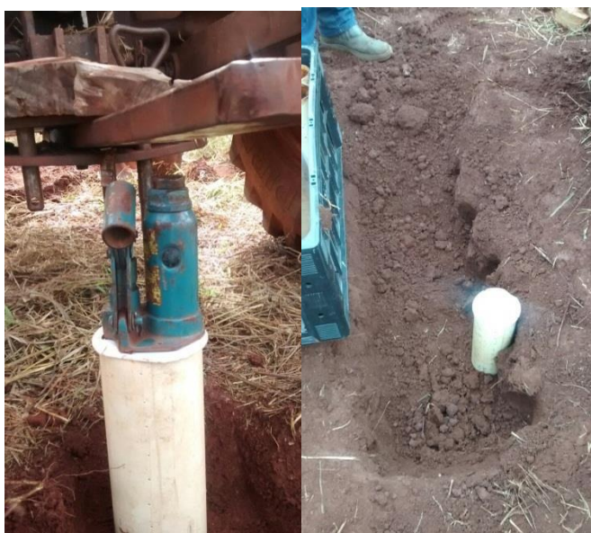
Figura 2 – Obtenção de amostra indeformada de solo sob cultivo por meio da inserção com atuação hidráulica do microlisímetro, e posterior remoção do conjunto.
