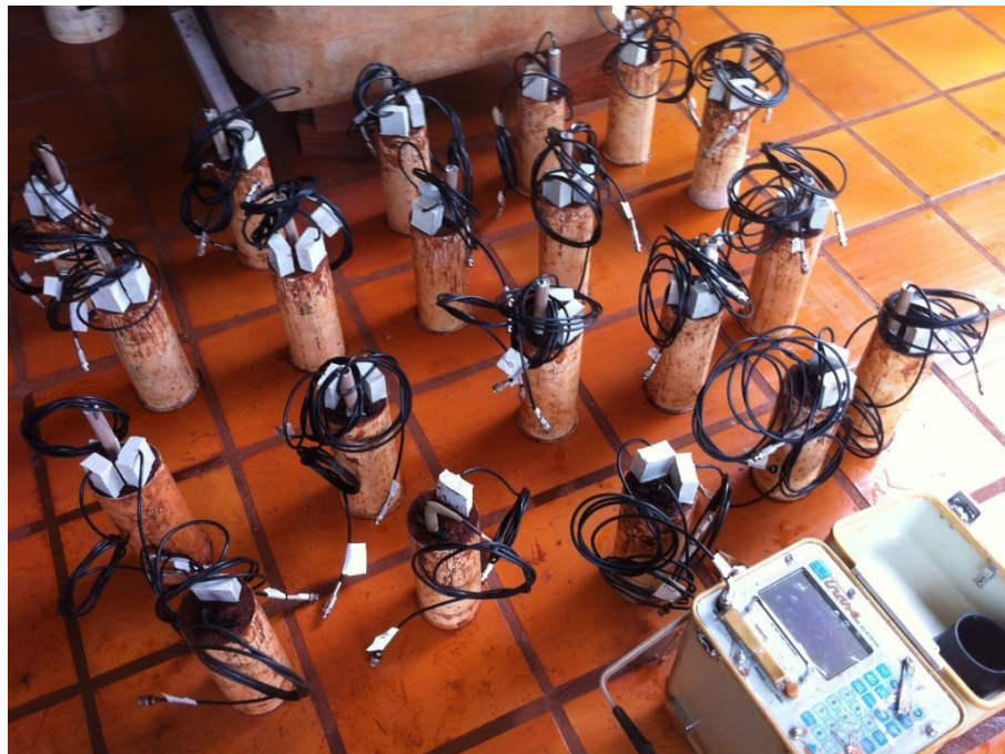
Figura 4 – Amostras indeformadas de solo sob cultivo e sob mata e sondas artesanais e originais instaladas no seu interior, para leitura de K_a com o TDR/TRASE.
