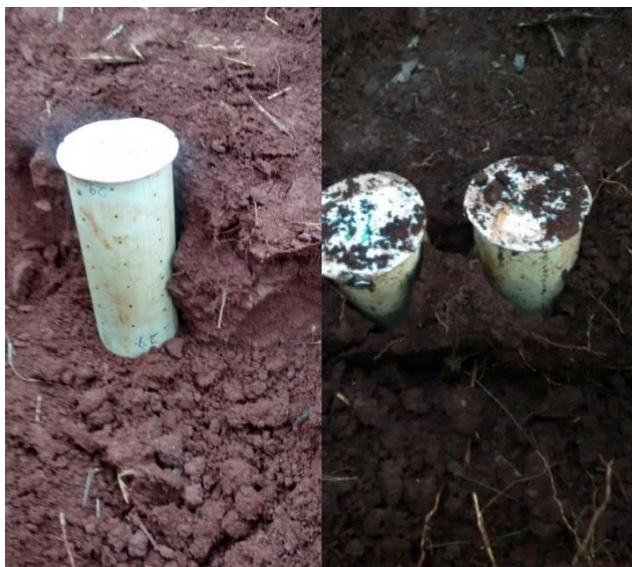
Figura 3 – Obtenção de amostra indeformada de solo sob mata por meio da inserção com atuação hidráulica do microlisímetro, e posterior remoção do conjunto.
