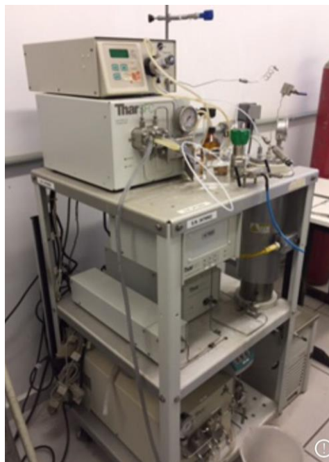
Figura 9: Equipamento antissolvente supercrítico (SAS) utilizado na microencapsulação/inclusão dos extratos na \beta -Ciclodextrina.
