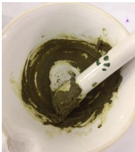
Figura 8: Kneading ou amassamento de \beta -Ciclodextrina e extrato de oliveira antes da secagem.
