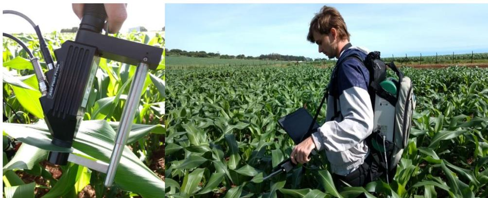
**Figura 8** - ASD Plant Probe com a folha climpada para obter a leitura espectral das plantas de milho no experimento utilizando o espectrorradiômetro ASD Fieldspec 3 Jr.
