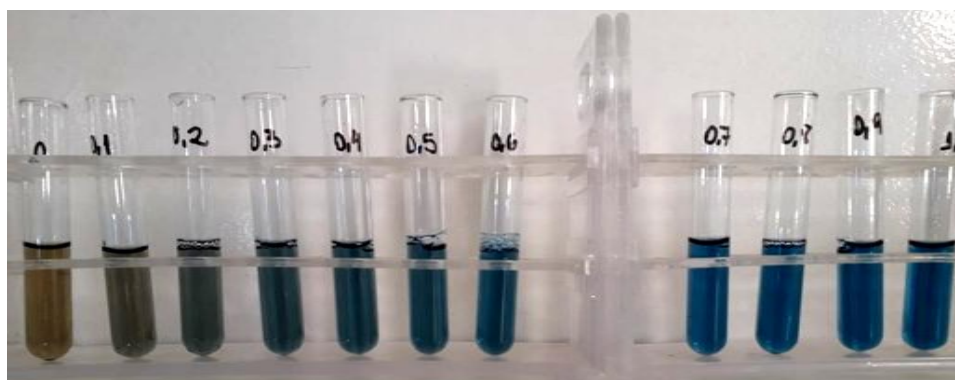
Figura 17 - Preparo das concentrações para a determinação da curva padrão de proteínas. Fonte: a autora
