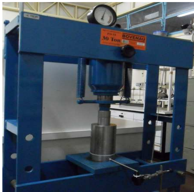
Figura 12: Prensa hidráulica com capacidade de 30 ton/cm 2 utilizada na extração do óleo de semente de uva
