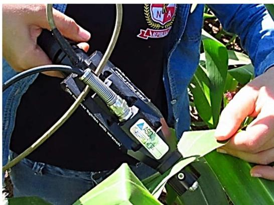
Figura 7. Exemplo de utilização do ASD Plant probe.
