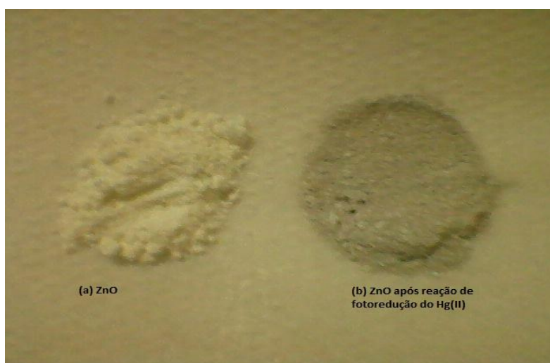
Figura 51 - Fotocatalisador ZnO, antes e após reação de fotorredução do \text{Hg}^{2+} .
