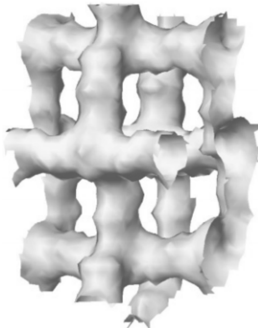
Figura 2.5 – Sistema poroso da zeólita ZSM-5 – Canais retos na horizontal e os sinusoidais na vertical Fonte: (Kulprathipanja, 2010)
