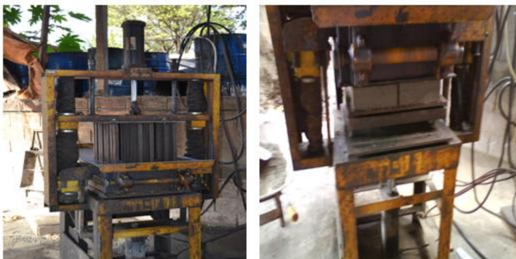
Figura II.10 – Máquina vibro-prensa com desforma sobre paletes (Fonte: Arquivo pessoal da autora)
