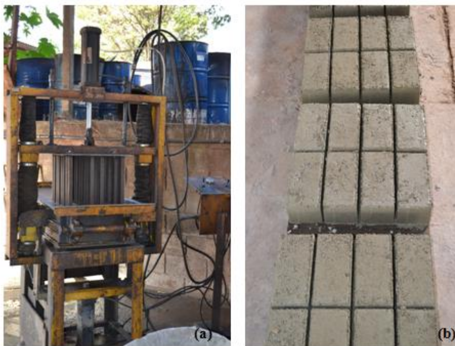
Figura IV.2 – (a) vibro-prensa pneumática e (b) desforma dos blocos em paletes
