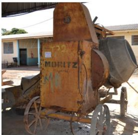
Figura IV.1 - Betoneira autocarregável utilizada na fabricação dos blocos
