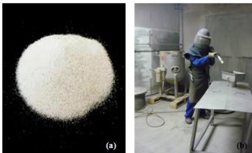
Figura II.5 – (a) Microesferas de vidro e (b) processo de jateamento de peças (Fonte: ATLASINOX e MICROESFERA, 2012)
