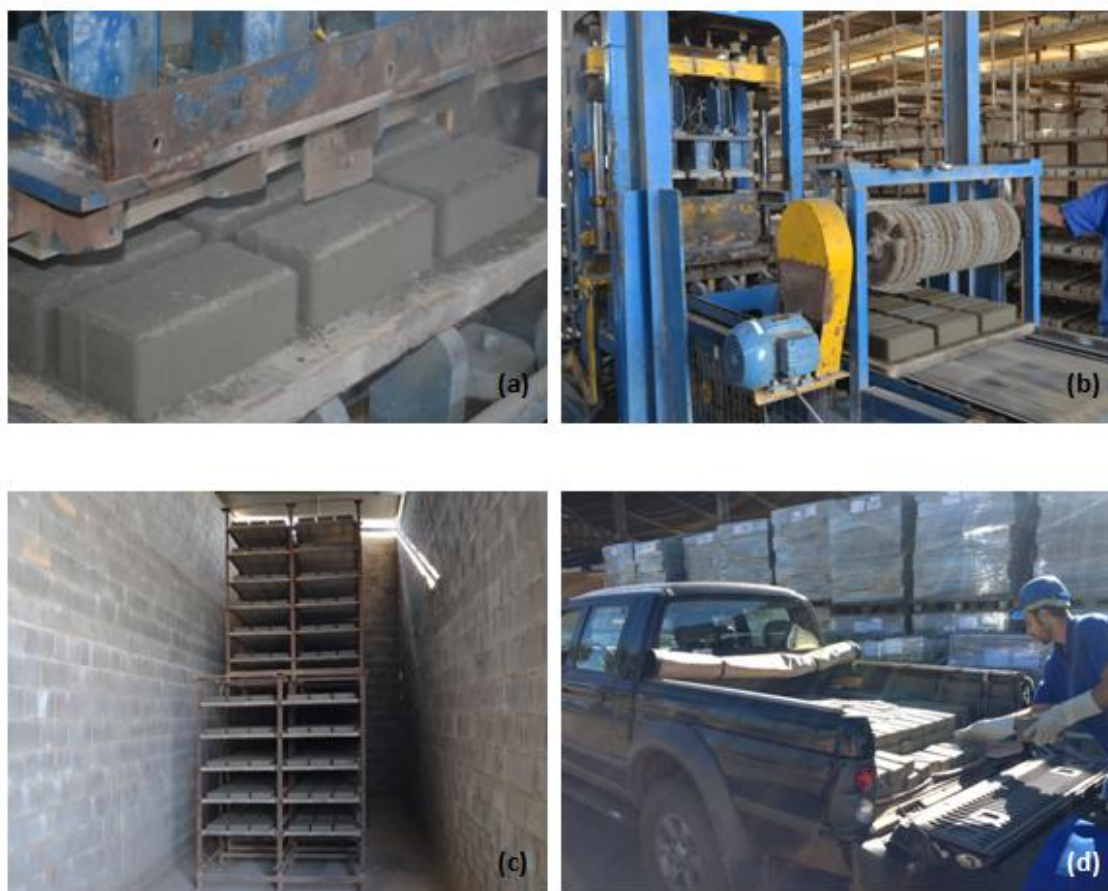
Figura V.2 – Momento da moldagem, cura e transporte dos blocos
