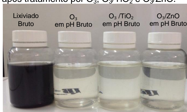
Figura 43 – Cor aparente do lixiviado bruto e após tratamento por O_3 , O_3/TiO_2 e O_3/ZnO .
