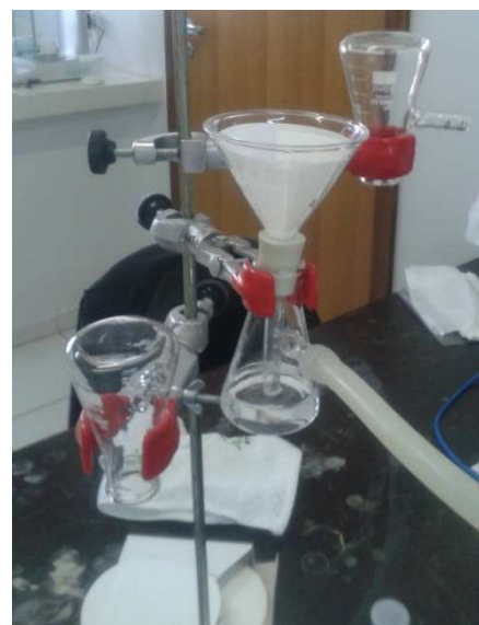
Figura 10 - Sistema de filtração a vácuo adaptado (a); Amostra filtrada a vácuo (b)
