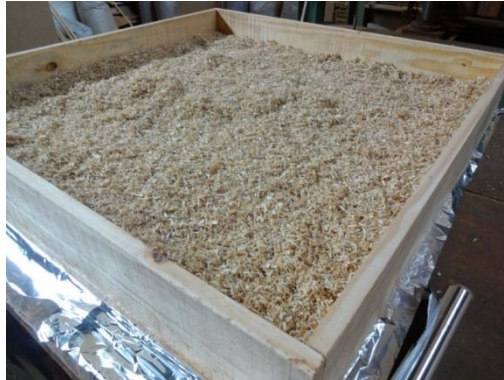
Figura 19 – Formação do colchão de partículas.
