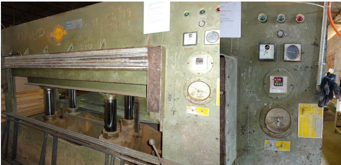
Figura 25 – Prensa utilizada na prensagem a quente com controle de temperatura
