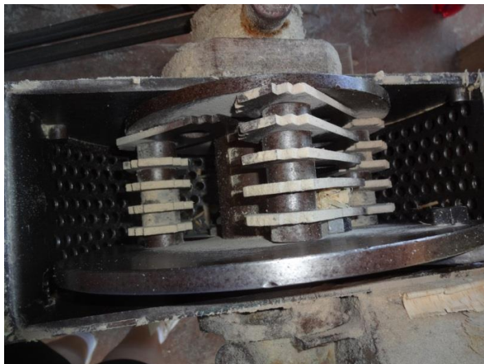
Figura 18 – Peneira interna do equipamento utilizado para triturar a maravalha.
