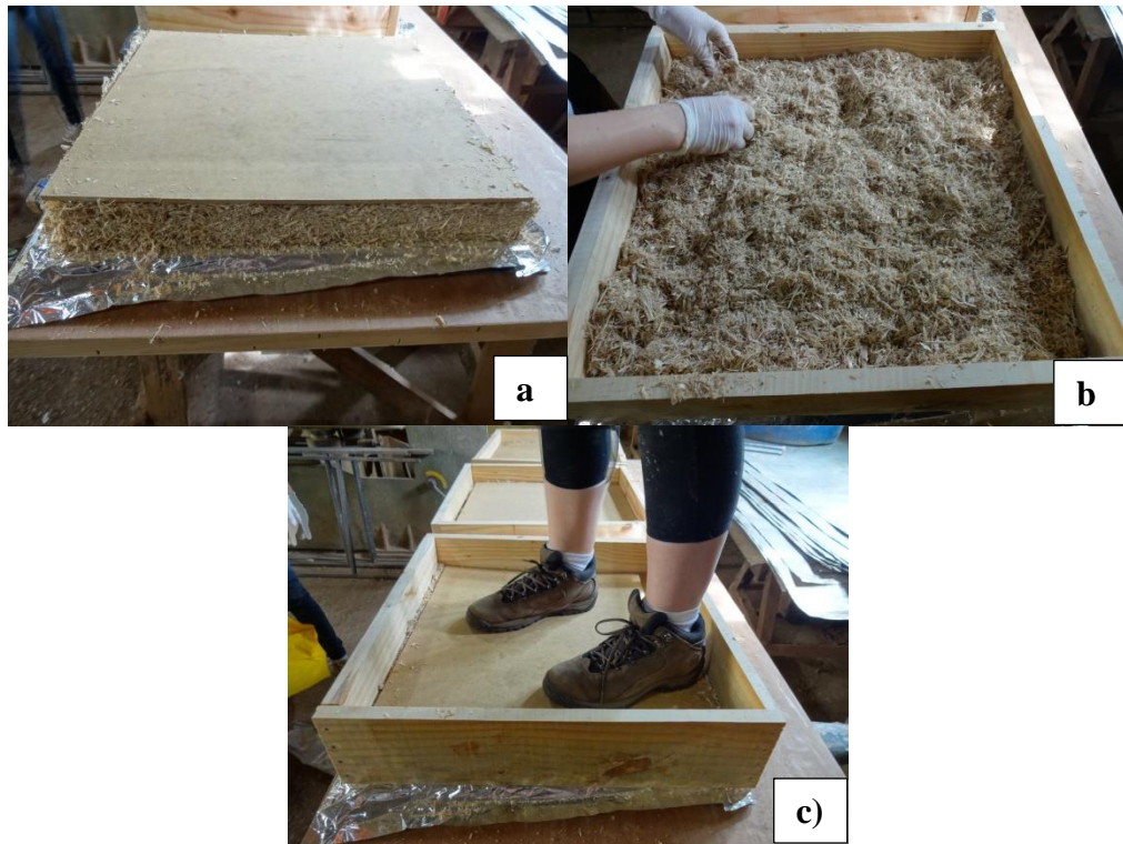
Figura 24 – Colchão de partículas e pré-prensagem do material
