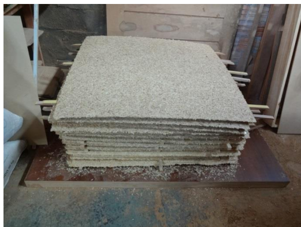
Figura 22 – Painéis após prensagem.
