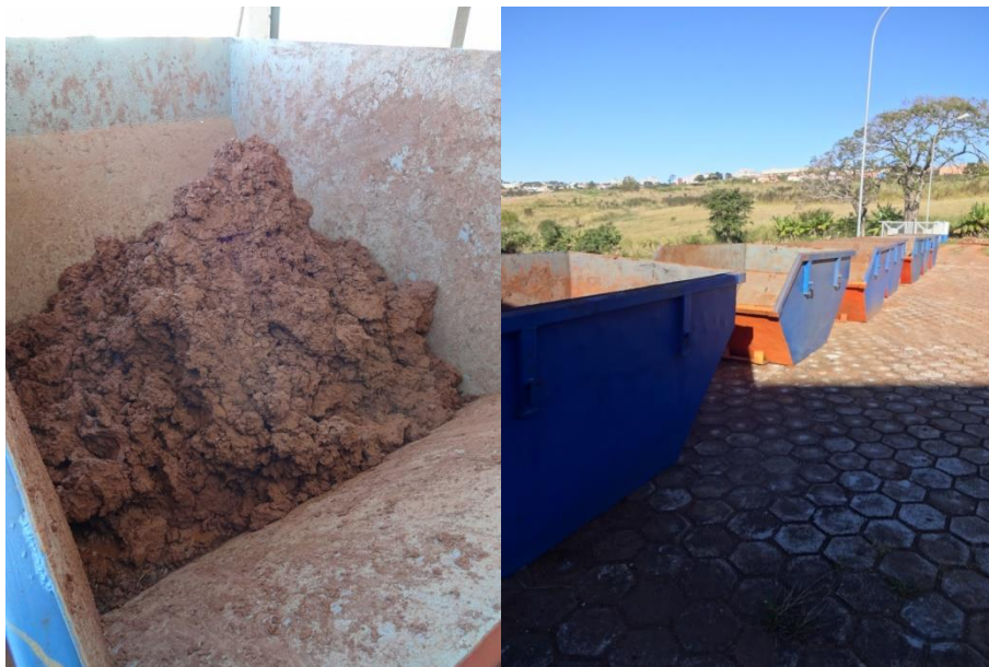
Figura 11 – Containers de armazenamento do lodo até destinação final
