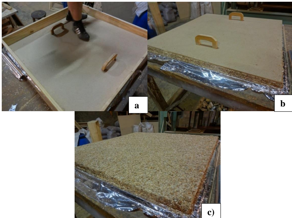
Figura 20 – a) Pré-prensagem do painel. b) e c) colchão pronto para prensagem a quente.
