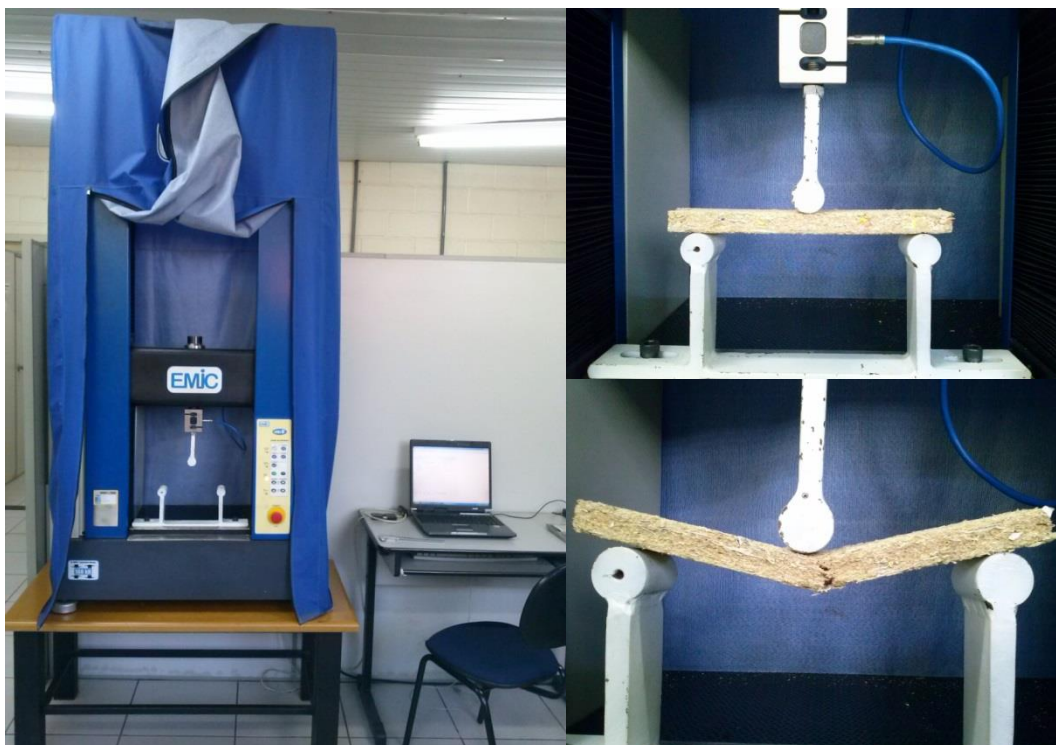
Figura 44 – Equipamento utilizado no ensaio de Flexão.
