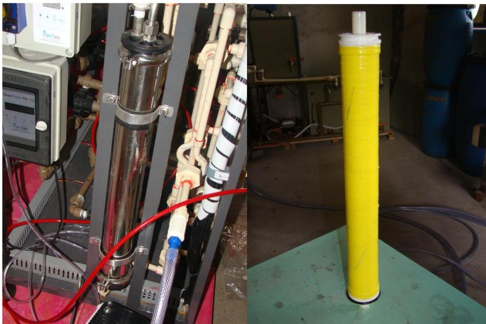
Figura 5.5 – Fotografia do suporte e o módulo de membrana de osmose inversa
