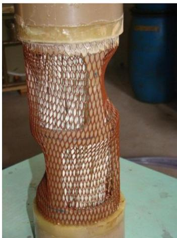
Figura 5.4 – Fotografia do módulo de membrana da microfiltração
