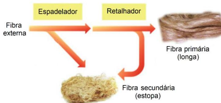
Figura 18 – Processo de separação das *fibras externas* em *primárias* e *secundárias* (Sisti et al., 2018 – adaptada).
