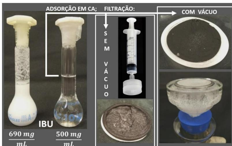
Figura 46 – Testes iniciais de complexação (adsorção) do IBU ao CA.
