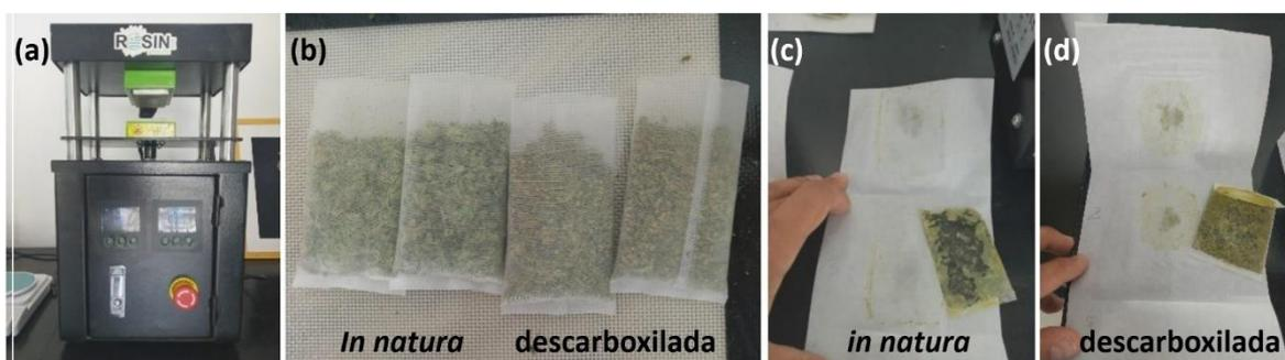
Figura 22 – Extração por prensagem a quente (variedade  $\beta 2$ ): (a) equipamento utilizado (RTP Rosin Press, RTPGAI024); (b) amostras com 4 g cada em malhas de 160  $\mu\text{m}$ ; (c) extrato de amostra *in natura* coletada em papel siliconado; e (d) mesmo procedimento aplicado à amostra descarboxilada.
