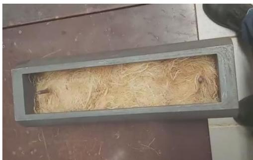
Figura 25 – Reator utilizado para o processo de pirólise.
