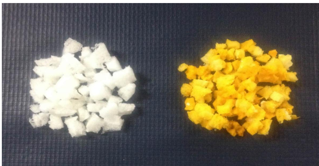
Figura 18. Espuma de poliuretano antes e depois da adsorção do corante Amarelo Procion HE 4R. Fonte: o autor.
